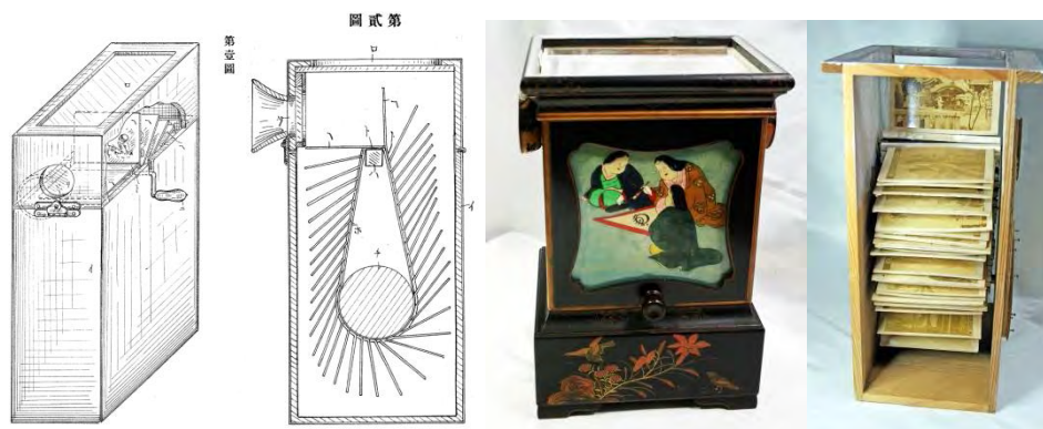
【図 7】実用新案「玩具活動寫眞」の内部説明図（1906 年）
