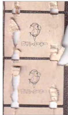
【図 1】パーフォレーションの失敗例 【図 2】 損傷例 【図 3】パーフォレーション加工前(松本夏樹コレクション)
