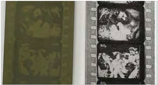
【図 17】フォトポリマーグラビュールによる試作例
