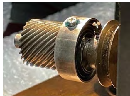
【図 6】 内部構造図（点線はフィルム走行、グラデーションは映写過程を示す） 【図 7】 香箱
