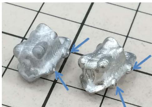
フラップターの胴体両側にある主翼の取り付け穴は浅いので（写真左）、0.5ミリのドリルで深くしておきます（写真右）。
